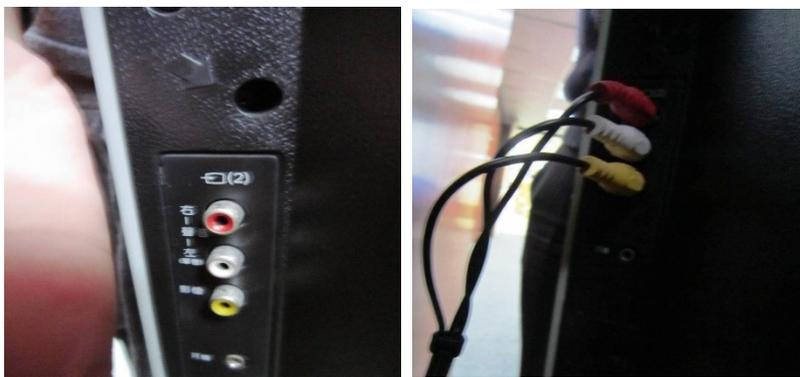
3. AV 端子線的一頭接上主機紅色圈處(A/V OUT)/將電源線接上紅色圈處(POWER IN)
